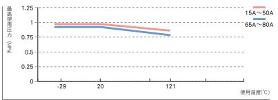
※ホースの最高使用圧力は継手により変わります。
